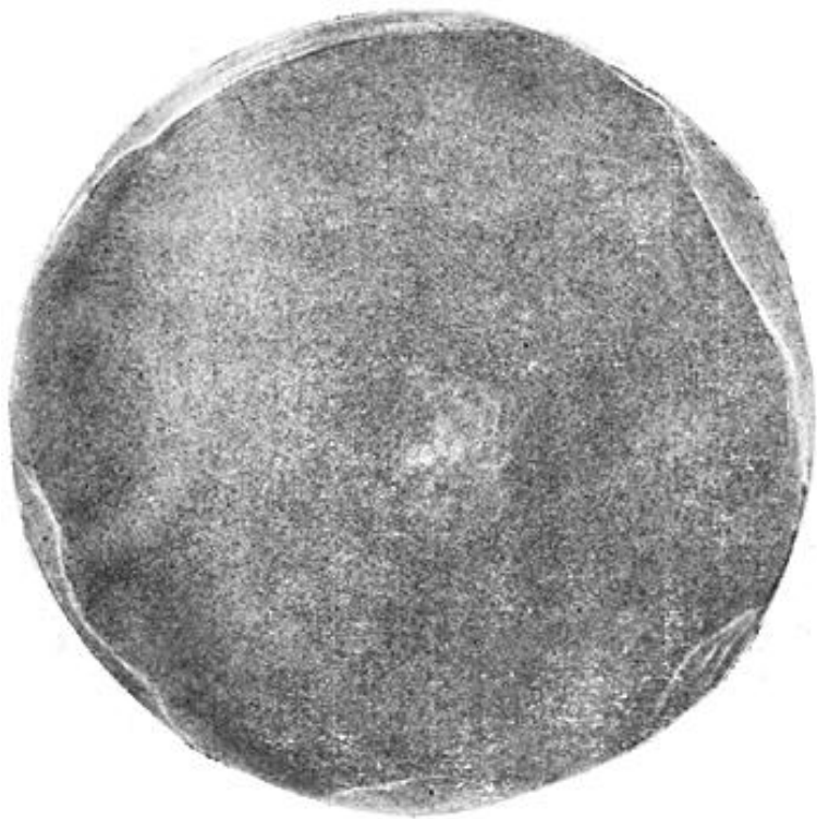
б - участки пониженной травимости без видимых загрязнений
